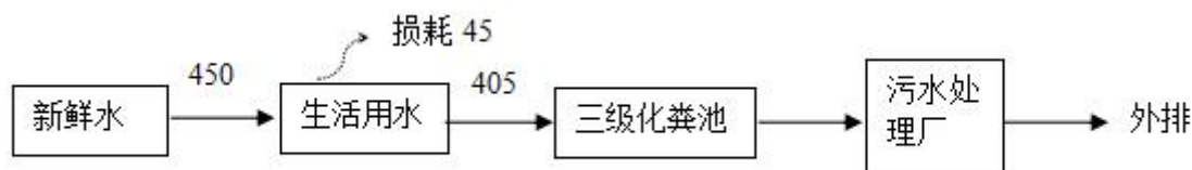
图 2-1 本项目水平衡图（单位 \text{m}^3/\text{a} ）
