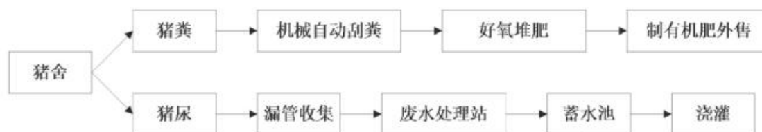
图 4.2-4 项目粪污处理工艺示意图
