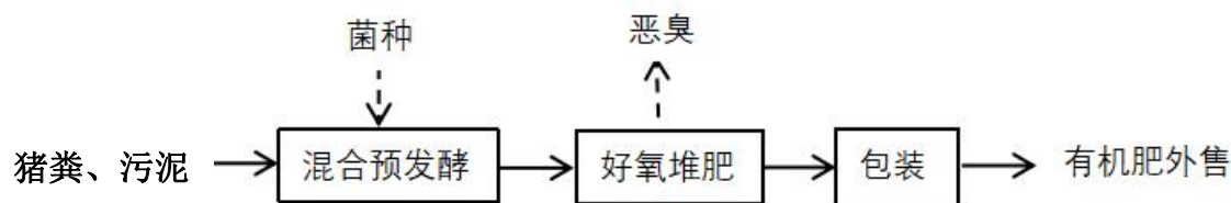
图 4.2-7 猪粪等制作有机肥料工艺流程图
