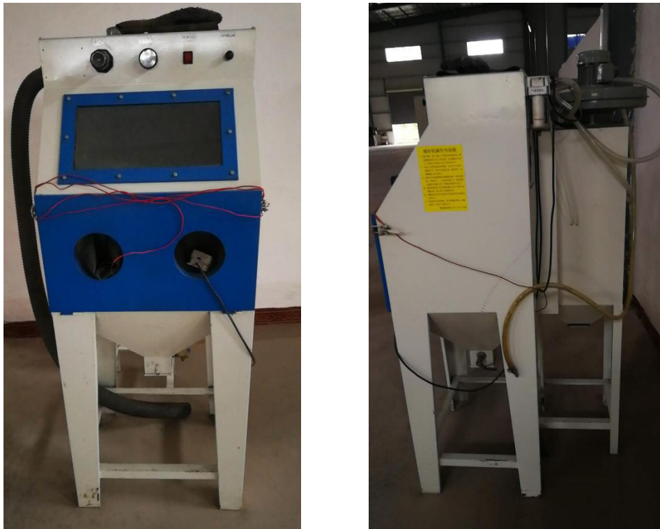
图 3 自带除尘系统喷砂机
